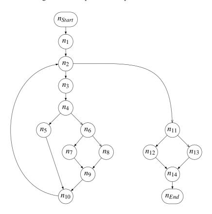
Abbildung 3.1: Kontrollflussgraph des Programms BinarySearch
