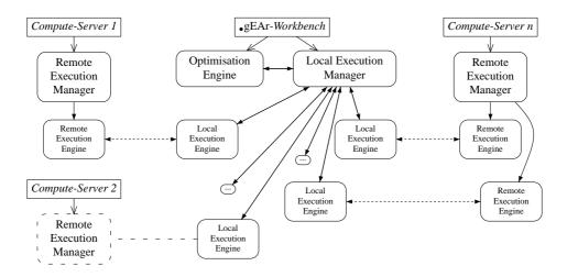
Abbildung 5.2: Architektur und Datenkommunikation der verteilten Testausführung in •gEAr
