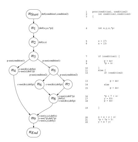
Abbildung A.6: Beispiel zu Pointer Aliasing in der Sprache C
