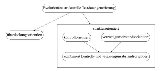
Abbildung 2.4: Klassifikation: Testdatengeneratoren mittels Evolutionärer Algorithmen
