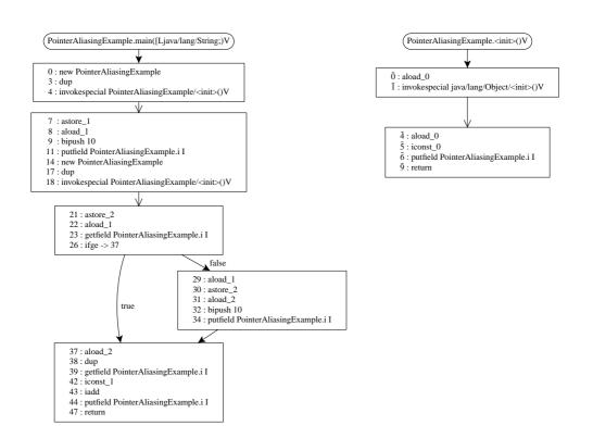
Abbildung 5.6: (I)CFG basierend auf dem Bytecode des Beispiels PointerAliasingExample
