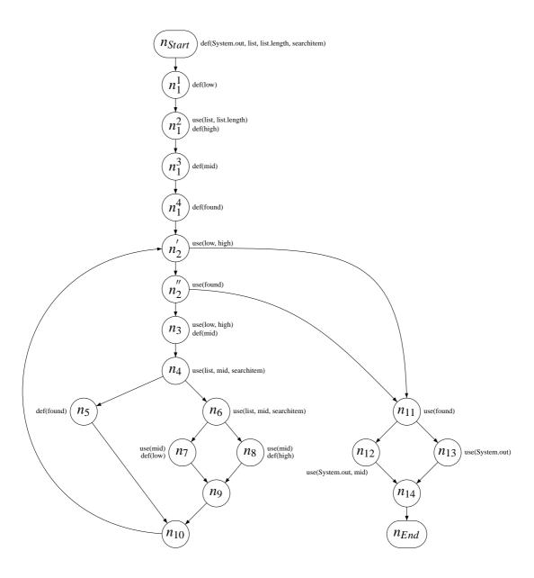
Abbildung A.3: Detaillierter  $dCFG_u$  für BinarySearch mit partial evaluation
