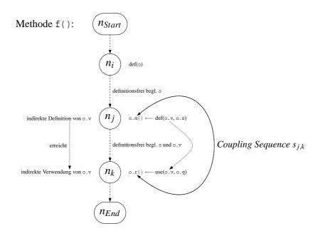
Abbildung 3.7: Beispiel einer intra-method coupling sequence
