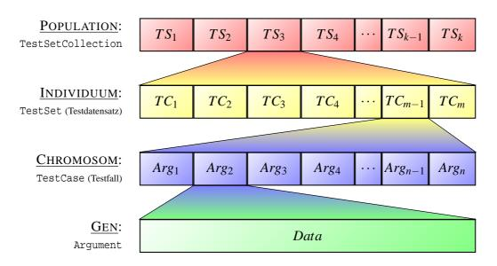
Abbildung 5.4: Datenstruktur bei der globalen Optimierung von Testdaten
