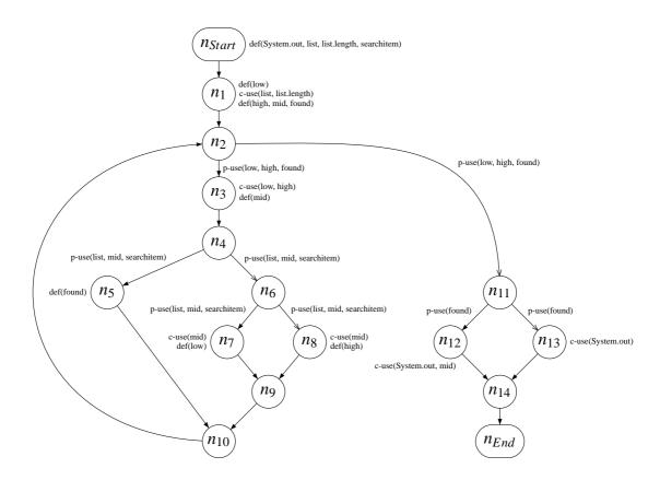
Abbildung 3.6: Datenflussannotierter Kontrollflussgraph des Programms BinarySearch
