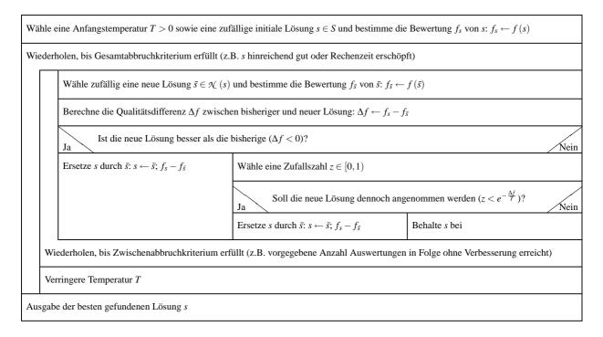
Abbildung 4.2: Struktogramm des Simulated Annealing Algorithmus
