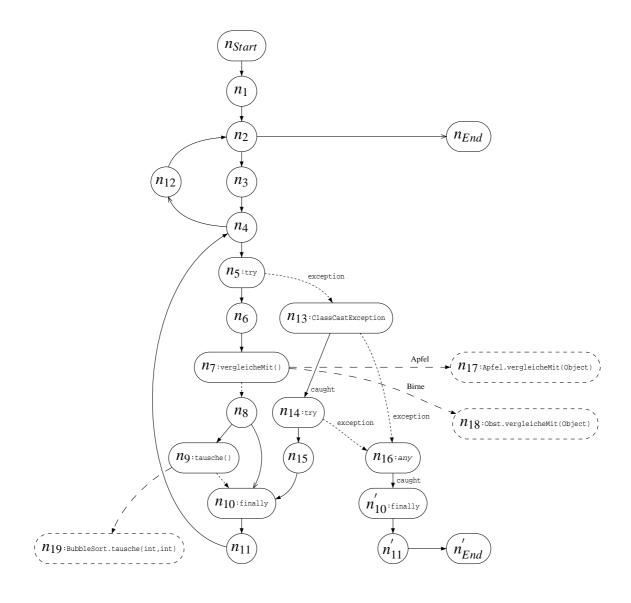
Abbildung 3.4: Kontrollflussgraph der Methode *BubbleSort.sort()*
