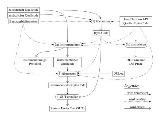
Abbildung 5.1: Analyse und Instrumentierung des zu testenden Systems (SUT)
