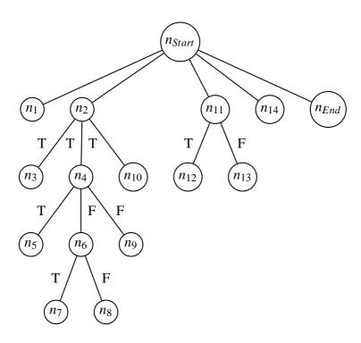
Abbildung A.1: Kontrollabhängigskeitsgraph (CDG) für BinarySearch
