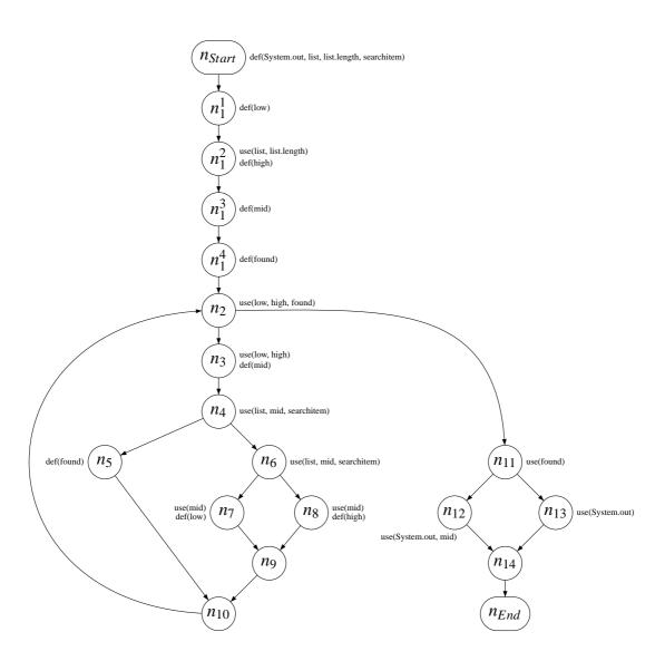
Abbildung A.4: Detaillierter  $dCFG_u$  für BinarySearch ohne partial evaluation
