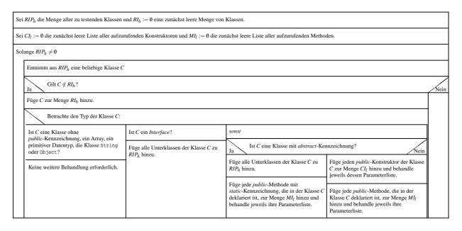
Abbildung 5.7: Verfahren zur Ermittlung der für den Test relevanten Entitäten
