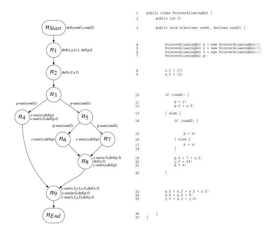
Abbildung 3.8: Kontrollflussgraph der Methode *PointerAliasingEx1.m(boolean, boolean)*
