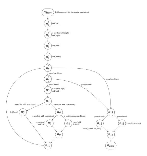
Abbildung A.2: Detaillierter  $dCFG_{cp}$  für BinarySearch mit partial evaluation
