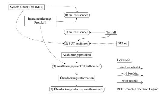
Abbildung 5.3: Ausführung des instrumentierten zu testenden Systems
